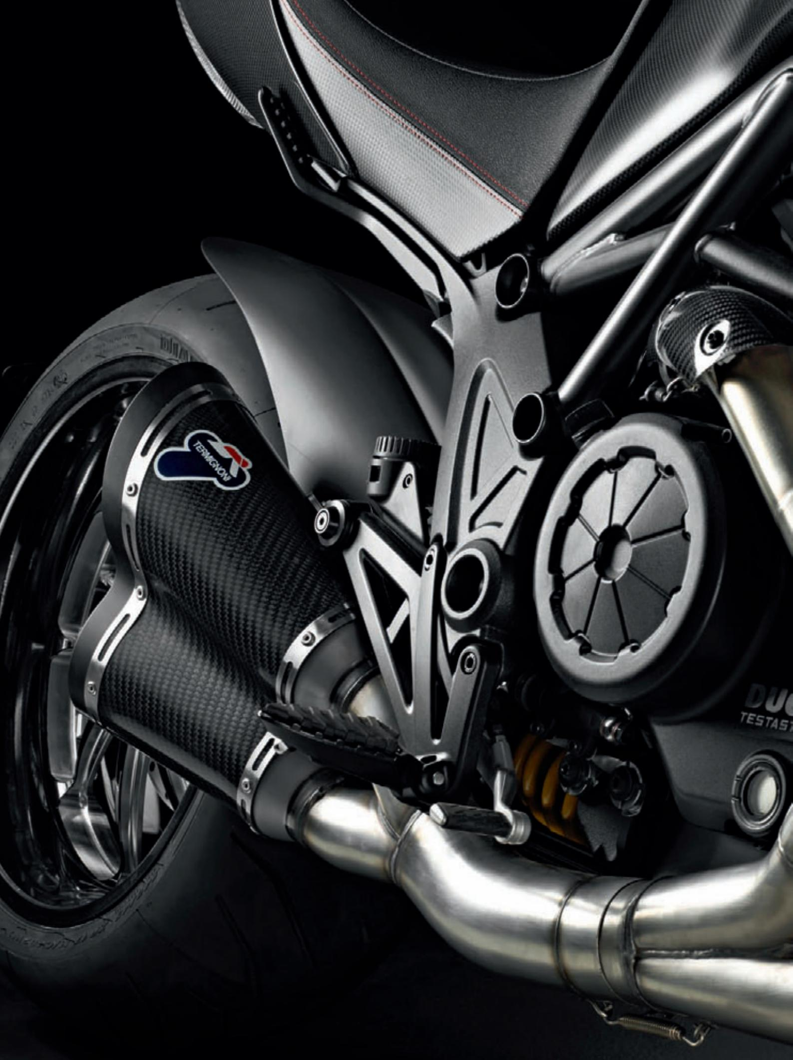
Terminale di scarico omologato in acciaio inox con fondello in fibra di carbonio. Il particolare design delle superfici e l'adozione di materiali pregiati, rende questo silenziatore un pezzo unico ed esclusivo.
