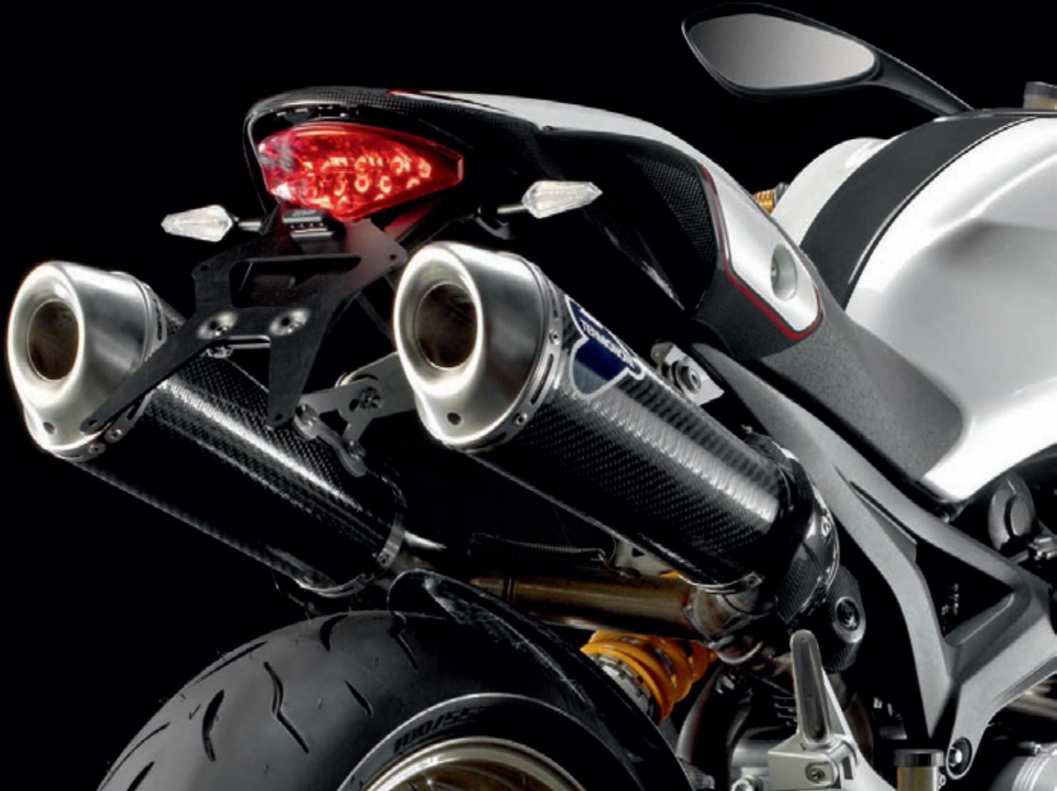
Realizzati in pregiato titanio, questa coppia di silenziatori omologati alleggeriscono la moto, arricchendola ulteriormente e donandole un suono ancor più pieno e corposo. La centralina elettronica ed il filtro aria ad alta efficienza in dotazione contribuiscono ad ottimizzare le doti di erogazione del motore sin dai bassi regimi mantenendo le emissioni entro i limiti imposti dalla normativa EURO3 (omologazione valida per i Paesi membri del UE).
