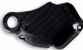
Cover superiore in carbonio per carter lato frizione; completa la protezione dei motori con frizione a bagno d'olio.
