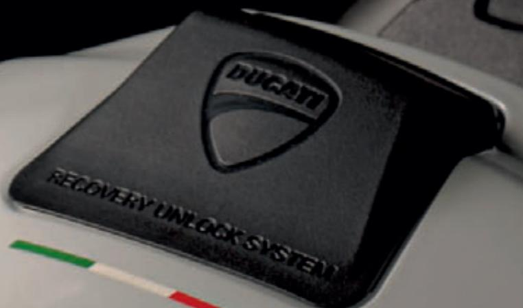
Grazie al sistema Hands Free la moto si accende al solo avvicinarsi; con il tappo serbatoio ad apertura elettrica anche l'operazione di rifornimento diventa fulminea e senza dover ogni volta usare chiavi e togliere guanti. Il tappo serbatoio elettrico Hands Free si sblocca automaticamente allo spegnimento della moto e si blocca nuovamente dopo 60 secondi in caso di mancato rifornimento, o all'accensione del mezzo.
