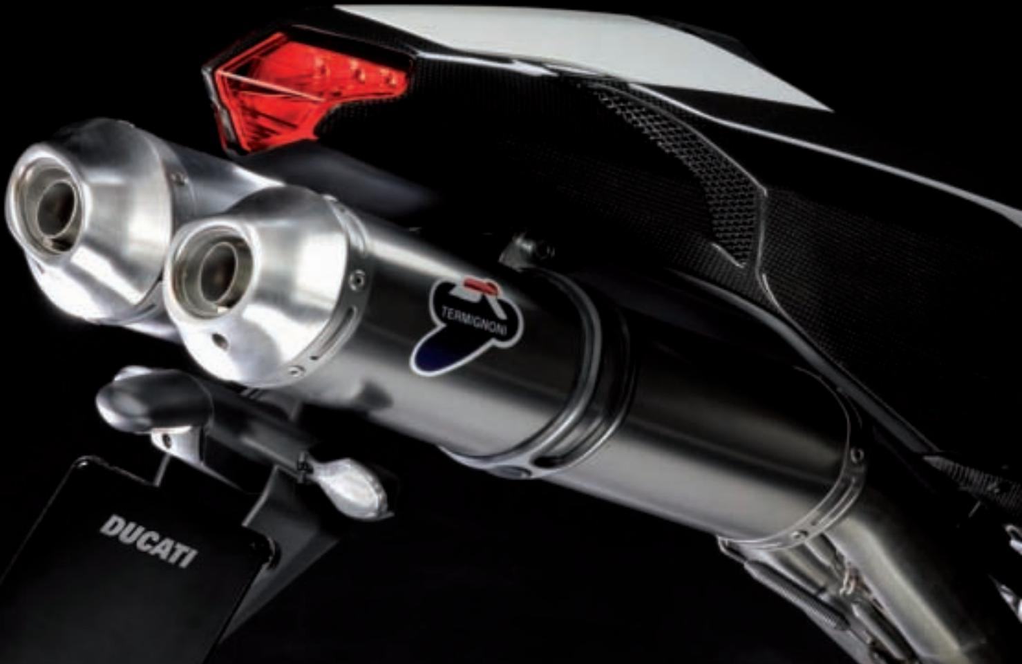
Kit composto da silenziatori omologati in titanio, centralina elettronica appositamente calibrata per ottimizzare il rendimento del motore e filtro aria ad alta efficienza.
