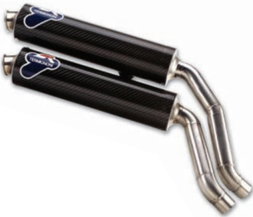
Coppia silenziatori laterali bassi in carbonio, omologati (in abbinamento al catalizzatore montato di serie sulla moto) in base alle norme UE in termini di inquinamento ambientale.
