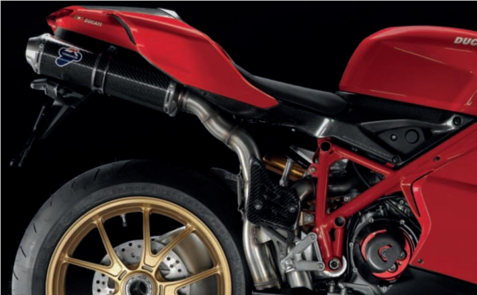
Kit Factory di potenziamento motore sviluppato da Ducati Corse. Il kit si compone di alberi di distribuzione cammes di scarico con profili racing, cornetti di aspirazione in alluminio da 70 mm e centralina con mappatura dedicata per l'utilizzo con il gruppo completo di scarico cod. 96119008B. L'adozione della medesima tecnologia utilizzata nel Campionato del Mondo Superbike, porta ad un incremento di potenza che raggiunge il 7%.
