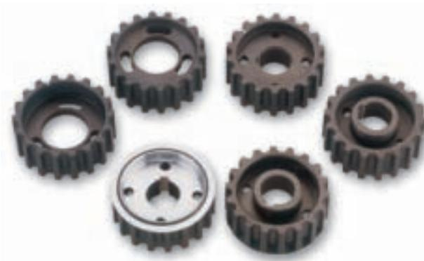
Serie pulegge distribuzione in Ergal sdoppiate con trattamento di ossidazione anodica dura - T=20. Peso dell'articolo di serie: 0,760 Kg. Peso del kit 0,280 kg. Alleggerimento 0,480 kg.
