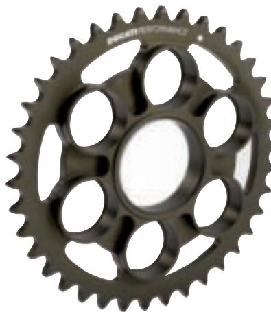
Corona racing in Ergal con trattamento di anodizzazione dura che garantisce grande leggerezza unita ad una maggiore resistenza all'usura. Spessore 6mm per catena passo 520.
