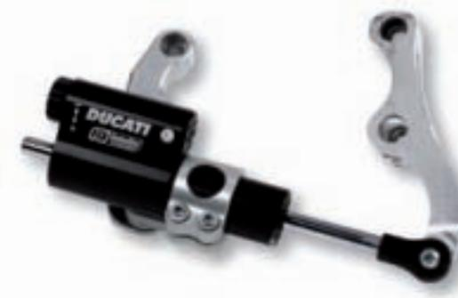
Ammortizzatore di sterzo trasversale in alluminio.
