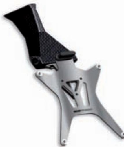
Porta targa smontabile in alluminio anodizzato nero, disegnato in due parti per essere facilmente smontato in caso di uso della moto in pista. Compatibile con la luce targa e le frecce di serie, questo porta targa consente di nascondere il passaggio cavi attraverso un setto tubolare, per la massima pulizia estetica.
