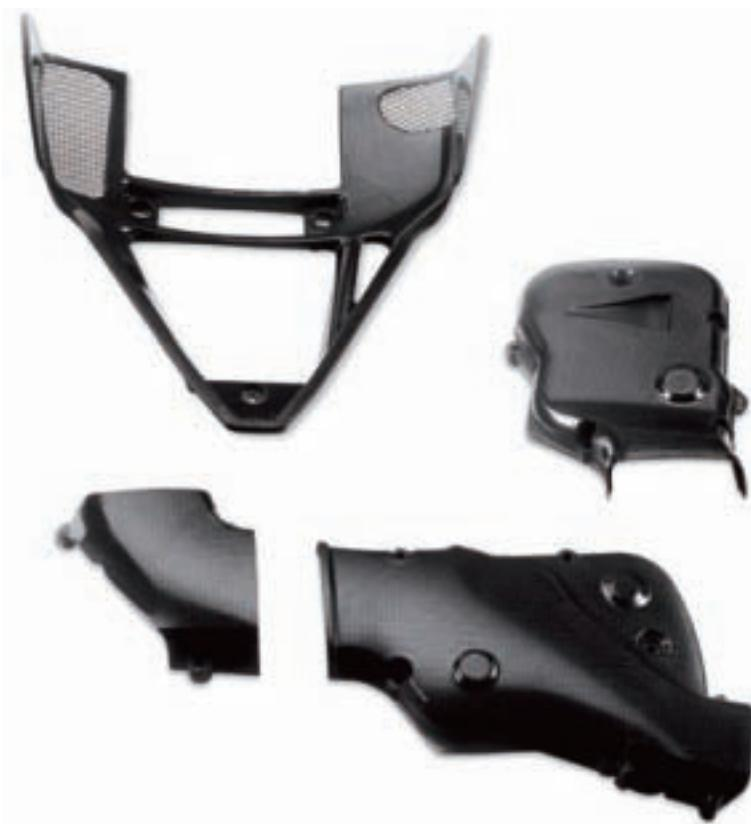
Protezione calore per silenziatore di serie, sostituisce quello in alluminio.
