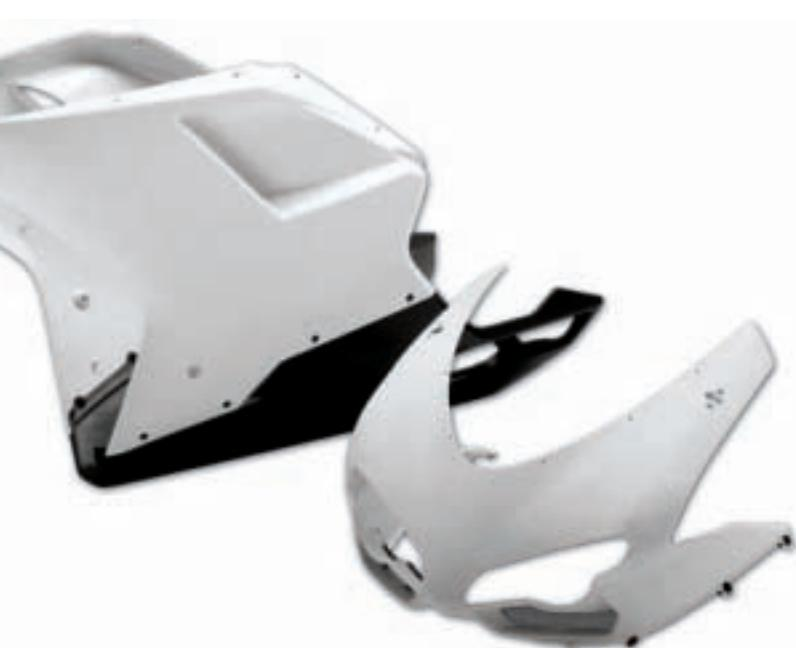
Carena inferiore in fibra plastica realizzata in unico pezzo per l'uso della carena codice 96984307B in pista. La vasca è realizzata per consentire l'uso del cavalletto laterale.
