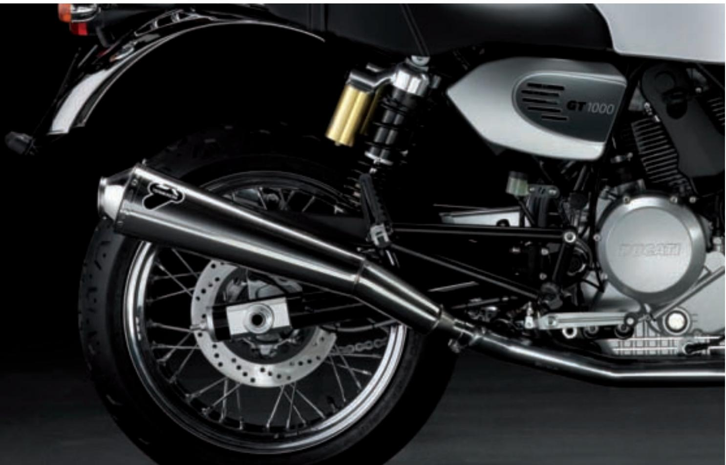
Kit silenziatori racing in acciaio con dB killer removibili; la centralina racing e la scatola filtro a corredo esaltano le doti del motore.
