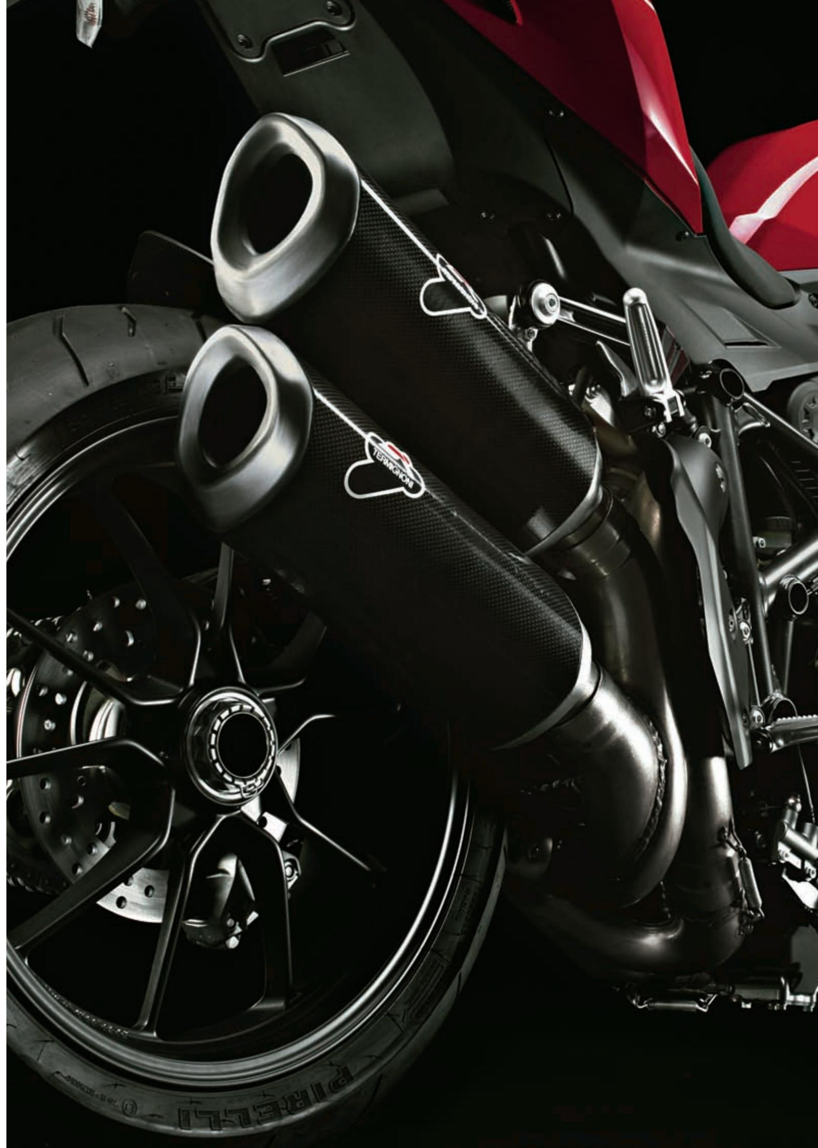
Coppia di silenziatori racing in fibra di carbonio con dB killer rimovibili; il design innovativo del profilo e la particolare sezione dei fondelli di uscita rendono la linea dello Streetfighter ancora più aggressiva e leggera. Il kit include il filtro aria racing e la centralina con mappatura dedicata, per un'esperienza di guida esaltante.
