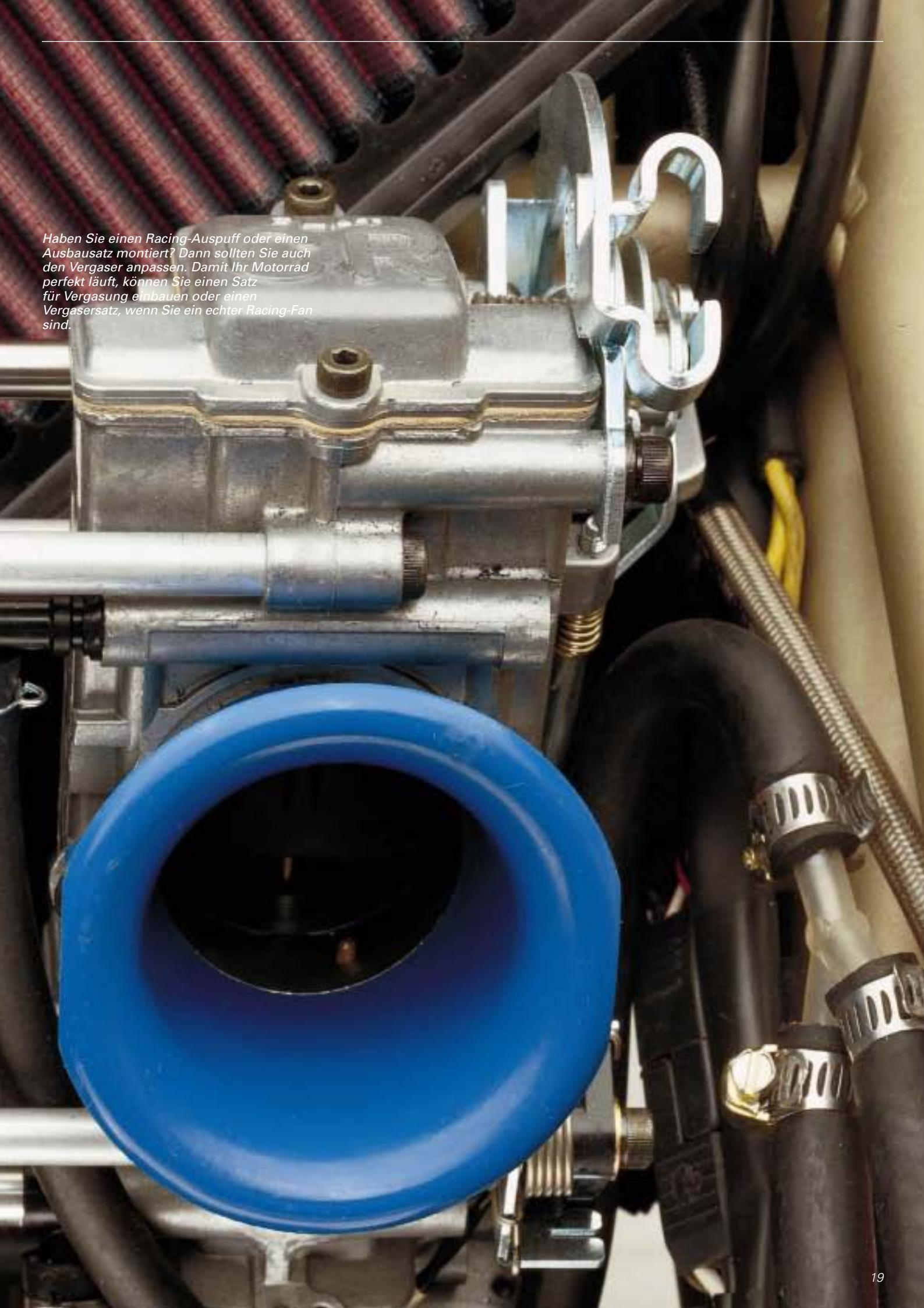
Haben Sie einen Racing-Auspuff oder einen Ausbausatz montiert? Dann sollten Sie auch den Vergaser anpassen. Damit Ihr Motorrad perfekt läuft, können Sie einen Satz für Vergasung einbauen oder einen Vergasersatz, wenn Sie ein echter Racing-Fan sind.
